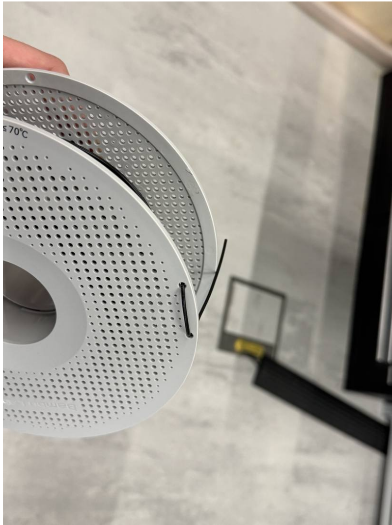
Filamentende durch ein Loch am Rollenrand gesteckt
