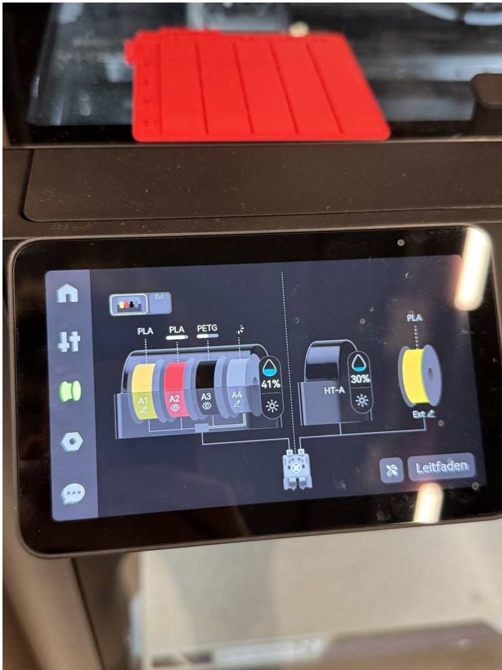
Drucker-Display: Übersicht über die AMS-Fächer (A1-A4) und das AMS HT (HT-A)
